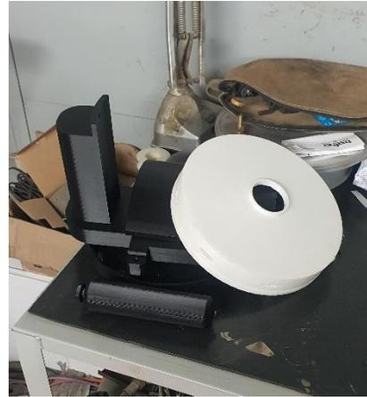
Como cualquier modelo de Producción este pasa por varios métodos para dar el acabado y ensamble acorde al modelo que se desea ensamblar en este punto las piezas se pinta con un aerógrafo con la pintura y color que se desea, se ensambla dichas piezas para dar el acabado final y así poder entregar los productos de la impresión 3D ya con la función que se desea en este cazo es hacer una Cafetera en forma de Un Generador de Vapor Clayton.
