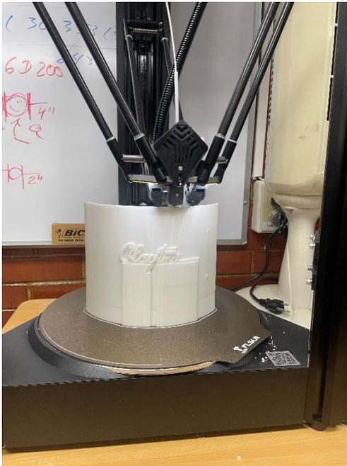
O próximo passo é colocar a impressora 3D ou impressoras para imprimir o modelo, para o desenvolvimento deste protótipo ele é composto por várias peças que precisam ser impressas de forma independente e uma vez que todas as peças estejam prontas elas param para um processo de detalhamento e limpeza
